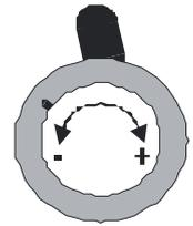
Durch Drehen am Drehknopf des Glas-Heizstabes verändern Sie den Schaltpunkt des Bi-Metall Reglers und damit die Soll-Temperatur der Ätzflüssigkeit.
