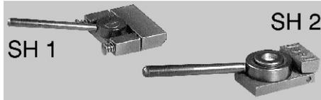
Spannvorrichtungen dienen zum Fixieren von Bauteilen auf T-Nuten Platten und RE-Profilen. Die Vorrichtungen werden mittels Schraube und T-Nutenstein auf der T-Nutenplatte montiert und klemmen das Werkstück über einen Excenter.
