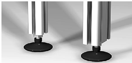
Höhenverstellbare Kunststoff-Gerätefüße mit Gummipatte. Zur Montage wird der Gewindebolzen in eine vorbereitete Gewindebohrung geschraubt. Durch Festziehen der Kontermutter wird die gewünschte Stellhöhe fixiert.
